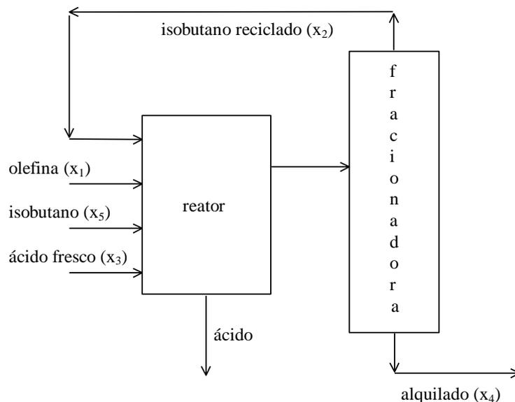
Há 10 variáveis de interesse, das quais  $x_1$ ,  $x_2$  e  $x_3$  são consideradas variáveis independentes (controladas). Estas três variáveis podem ser fixadas pelo operador por ajuste de set-points nos instrumentos de controle. O objetivo é determinar valores das variáveis independentes os quais maximizam o lucro da planta.
