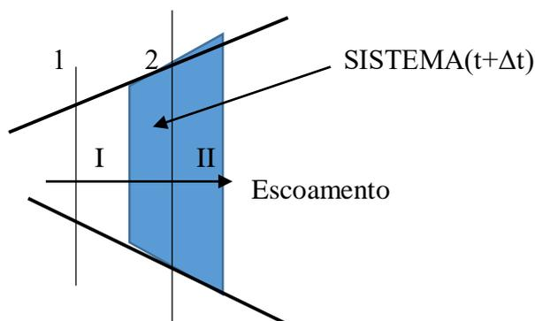
No instante  $t+\Delta t$ : o SISTEMA se move na direção do escoamento com velocidade  $v_{b1}$  na seção 1 e  $v_{b2}$  na seção 2. Por causa desse movimento, a região denominada de I no VC fica descoberta pelo SISTEMA e o SISTEMA cobre a região denominada de II, que não faz parte do VC. Assim, em  $t+\Delta t$ , tem-se:
