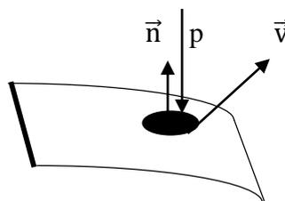
No elemento de área tem-se o vetor  $\vec{n}$  normal superfície, a pressão  $p$  sempre normal à superfície e a velocidade  $\vec{v}$  que faz um ângulo  $\theta$  com a normal à superfície. A pressão pode ser exercida para dentro ou para fora do elemento de área. O trabalho relativo à força de pressão que atua numa área  $A$  é:
