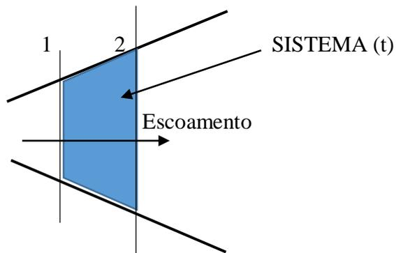
1 e 2 são duas superfícies de controle que definem um Volume de Controle (VC) para o campo de escoamento; essas duas superfícies são normais à direção do escoamento.
