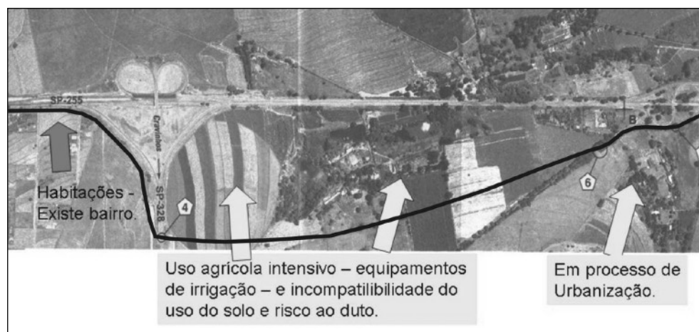
FIGURA 29.10 – incompatibilidades com o uso do solo nas proximidades de duto implantado em Ribeirão Preto-SP. Fonte: Souza, Montaño & Oliveira (2007)
