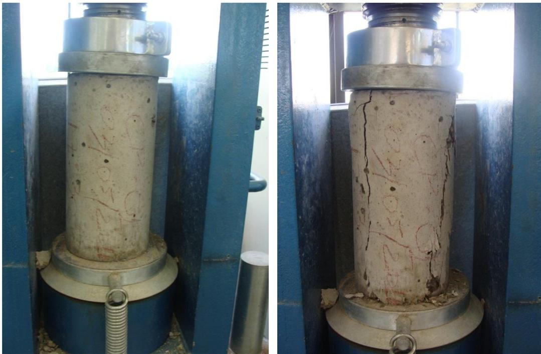
**Figura 1** – Ensaio de resistência à compressão de concreto com ruptura tipo coluna – observar fissuras verticais paralelas.
