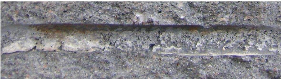
**Figura 9** – Aspecto da superfície de contato entre concreto e aço de um corpo de prova "aberto" após ensaio – aço com superfície lisa, tipo CA-25.
