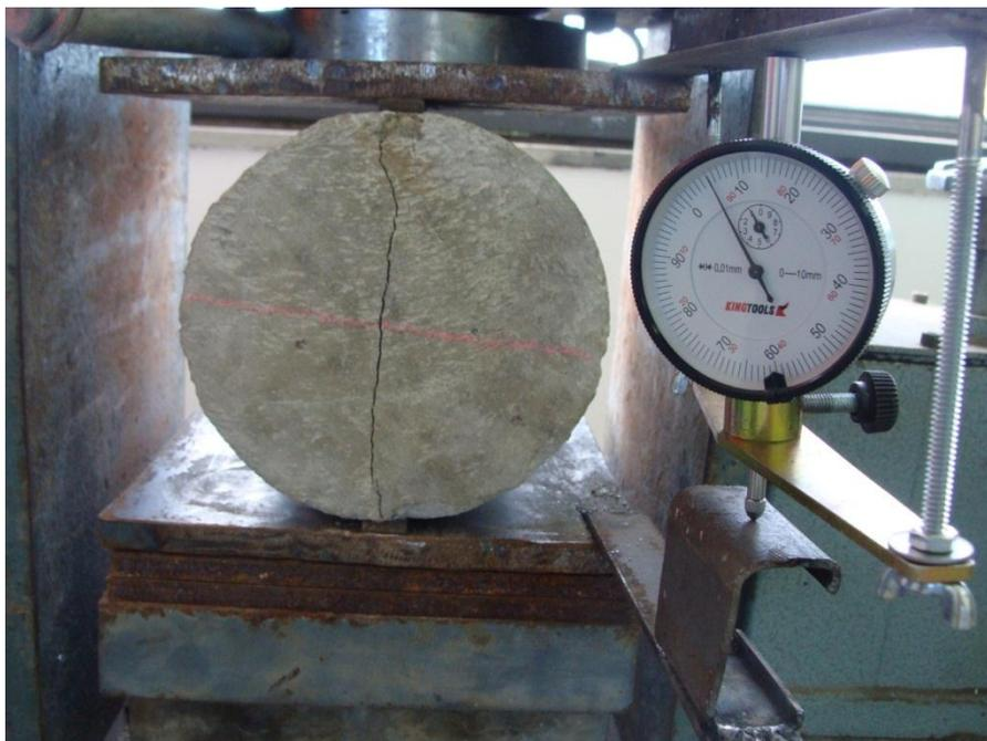
**Figura 3** – Ensaio de compressão diagonal com armadura de fendilhamento.
