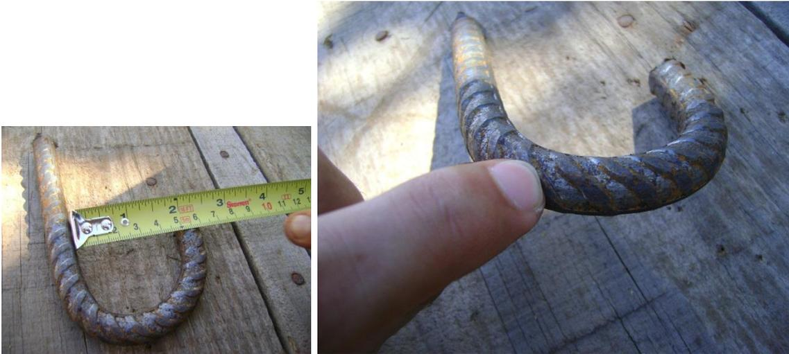
**Figura 7** – Dobramento a 180 graus de barra de 12,5mm com diâmetro de dobramento de 5cm com formação de fissuras, feito na obra, mostrando inadequação do material.
