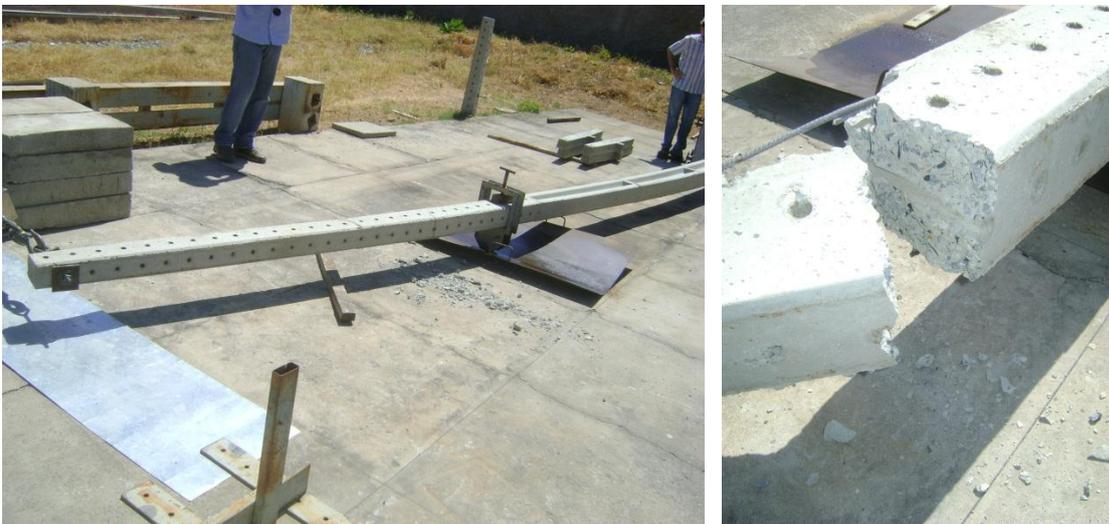
**Figura 6** – Ruptura brusca de seção subarmada de um poste de concreto verificada em ensaio que demonstrou fragilidade incomum de um dado lote de aço CA-60.
