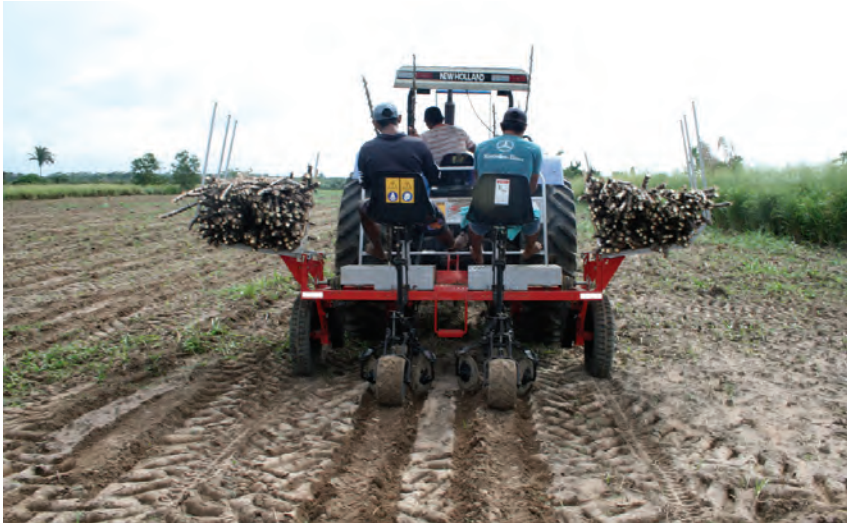
Figura 1. Plantio mecanizado de mandioca com máquina para duas linhas.
