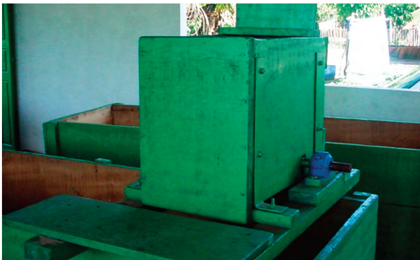
Figura 12. Peneiramento mecânico da massa escaldada.
