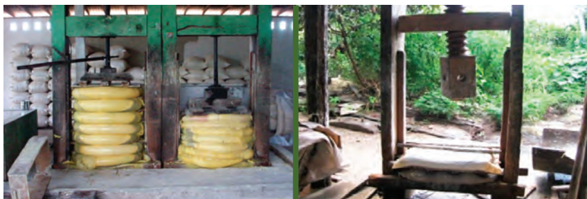
Figura 8. Exemplos de prensas manuais.
