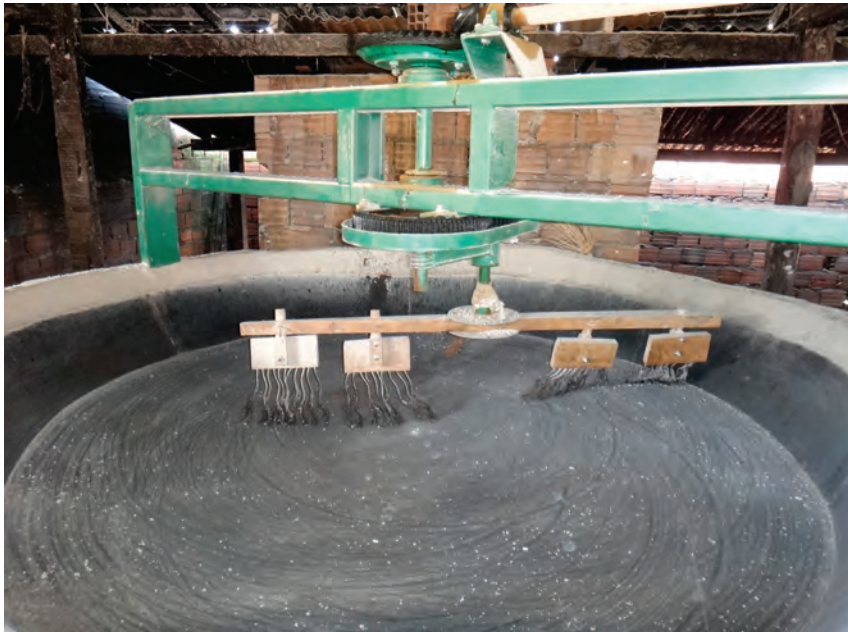
Figura 11. Forno mecânico utilizado para torragem e espcamento da farinha de tapioca, em 2014.
