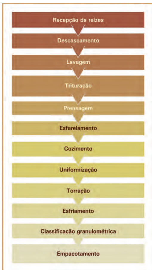
Figura 1. Etapas do processo para fabricação de farinha de mandioca.
