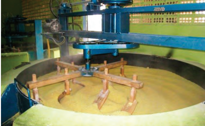
Figura 14. Torração da farinha e forno mecânico.
