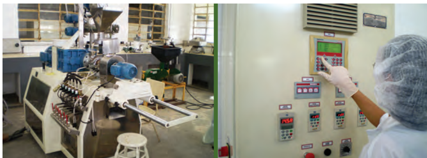
Figura 2. Extrusora e painel de controle.
