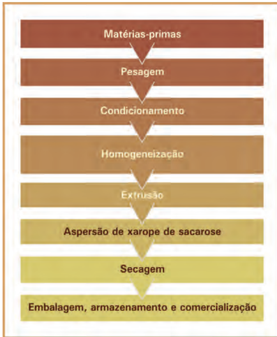
Figura 1. Fluxograma do processo de produção do cereal matinal extrudado.
