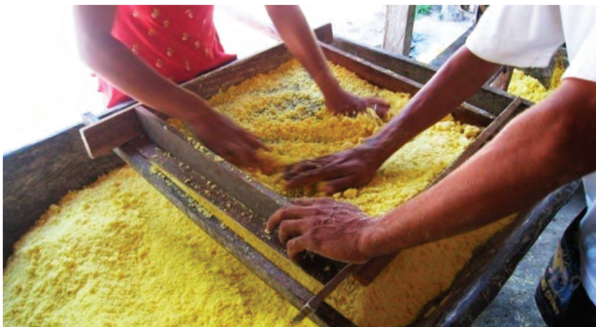
Figura 13. Peneiramento manual da massa escaldada.
