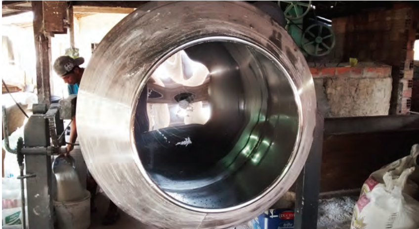
Figura 10. Betoneira elétrica de aço inox sem as aletas de turbilhonamento utilizada para encaroçamento da massa, em 2014.
