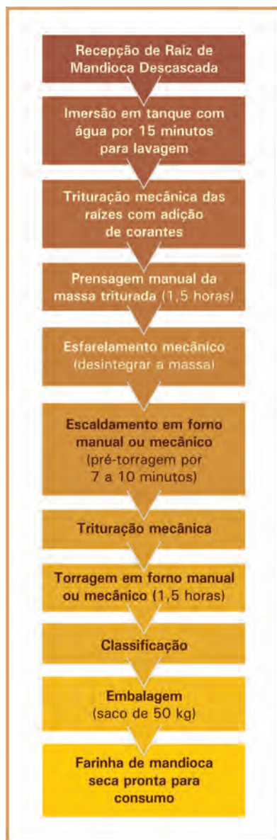
Figura 8. Fluxograma de processamento semimecanizado da farinha de mandioca-seca no Município de Castanhal, PA, 2014.
