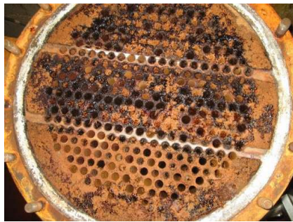
Incrustações em tubos de trocadores de calor
