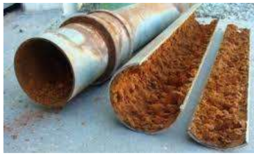
Incrustações em tubos de trocadores de calor
