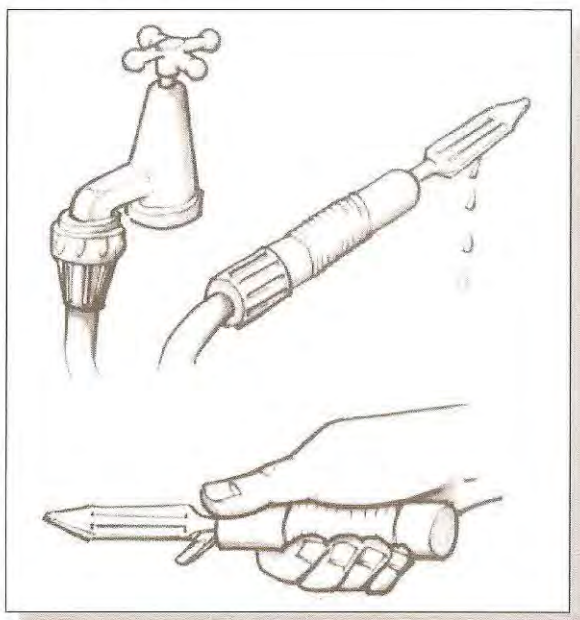
Figura 7.6. Conceitos de novos descascadores, derivados da análise de tarefas
