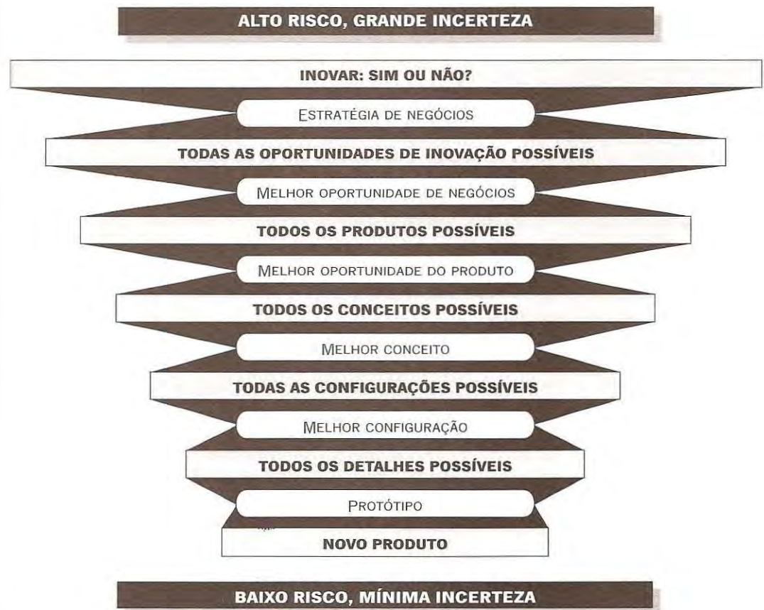
Figura 2.2. Funil de decisões, mostrando o processo convergente da tomada de decisões, com a redução progressiva dos riscos.
