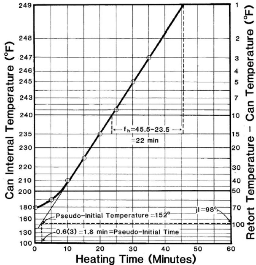
Temperatura da autoclave ( $T_{\infty}$ ) = 250 °F
