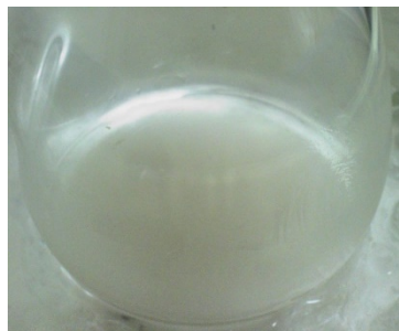
O reagente de Grignard é resfriado a 0 °C antes da adição do composto carbonílico. A solução torna-se leitosa.
