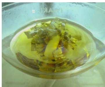
Tetrahidrofurano e alguns cristais de iodo são adicionados.
