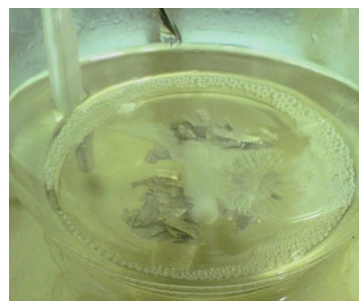
Uma solução de brometo de alquila é adicionada enquanto aquece.
