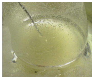
Uma solução do composto carbonílico é adicionado ao reagente de Grignard.
