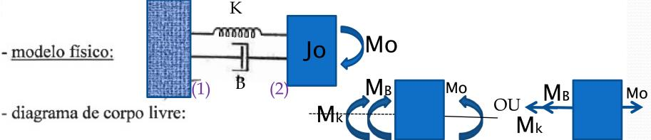
TMA (2a. Lei de Newton)  $\rightarrow J_{\alpha}\vec{w} = \vec{M}_{\alpha\alpha\gamma}$ modelo matemático:
