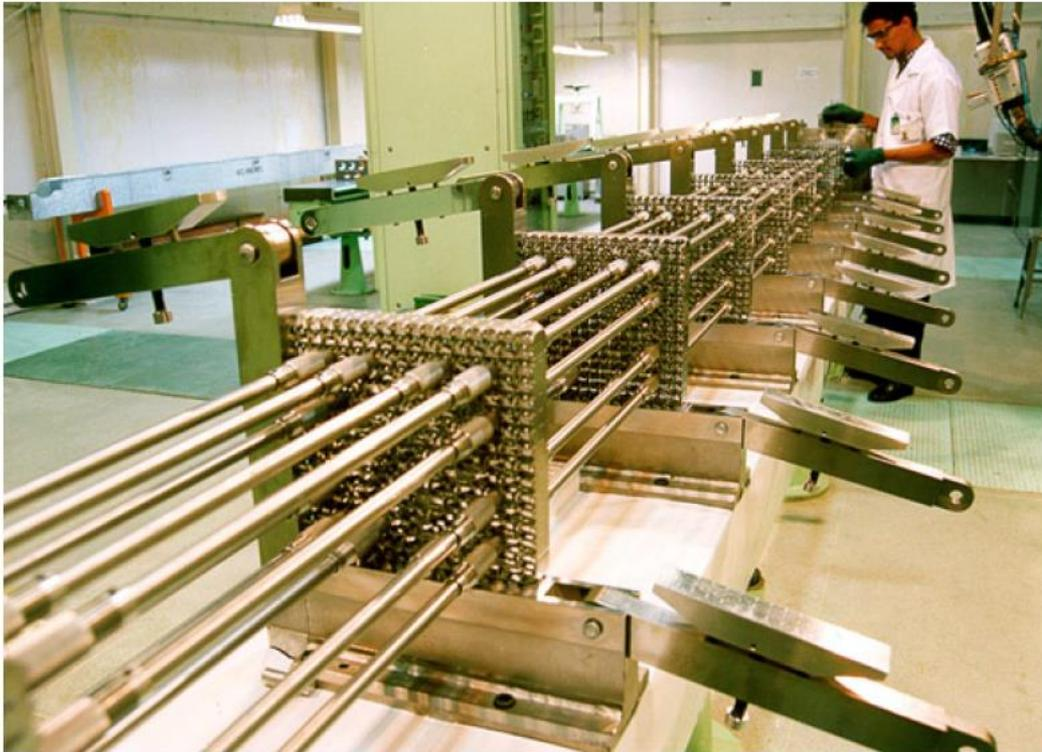
As varetas são colocadas em um conjunto para formar um “elemento combustível” posicionados numa matriz de malha quadrada. Esta disposição geométrica permite a circulação de água entre as varetas, e assim a remoção de calor gerado dentro do núcleo do reator. Num reator de água pressurizada esta estrutura é aberta e a água pode circular transversalmente no elemento.
