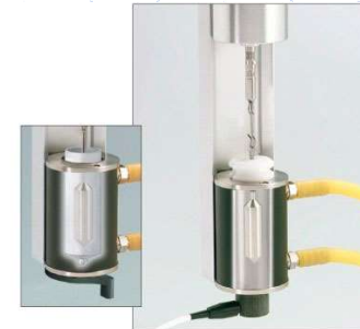
Esquema do Viscosímetro Rotacional. Fonte: https://www.braseq.com.br/viscosimetro-rotacional-brookfield
