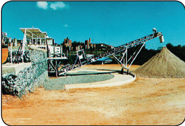
Foto 19 – Usina de reciclagem de entulhos
