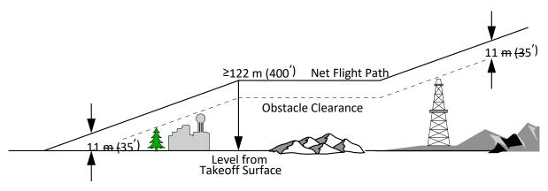
Figure 24-2 NET TAKEOFF FLIGHT PATH
