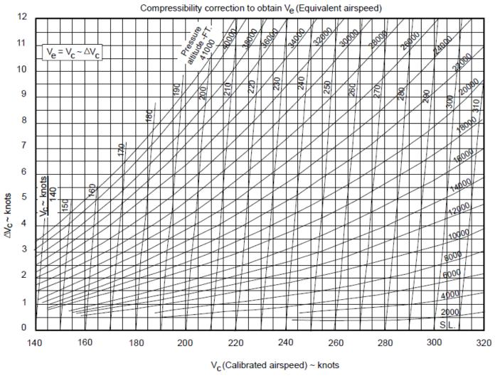
Figure 5 – COMPRESSIBILITY CORRECTION TO GAS
