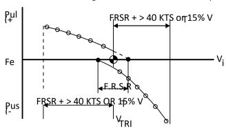
Figure 70-1 STATIC LONGITUDINAL STABILITY DATA
