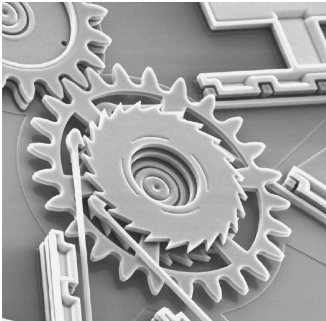
Análise microscópica de mecanismo de catraca fabricado em silício
