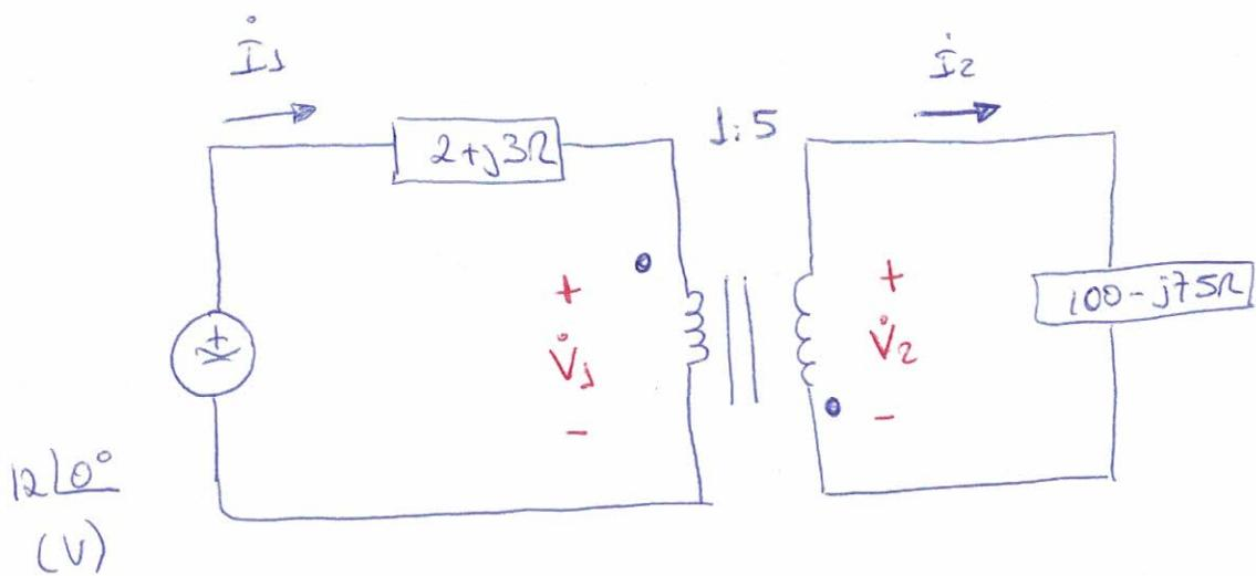
SOLUCIÓN 1: Vamos substituir o circuito  $z_{\text{an}}$  e o transformador  $\rightarrow$  referenciar o  $z_{\text{an}}$  ao  $z_{\text{an}}$
