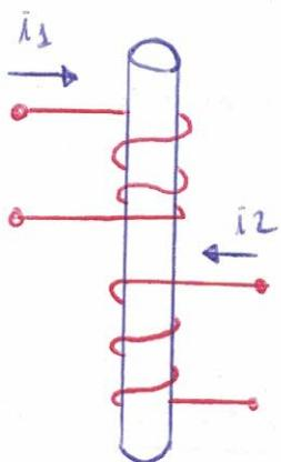
A partir da consideração da direção do fluxo magnético produzido por cada bobina, mostra-se que os pontos podem ser colocados ou no terminal superior de cada bobina ou no terminal inferior.
