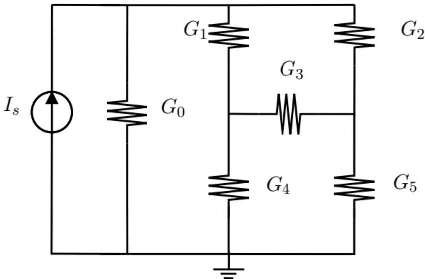
Determine todas as tensões nodais em função de  $I_s$  e das condutâncias do circuito.
