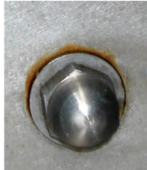
Corrosão por frestas sob a cabeça de um parafuso de aço 316 utilizado para fixar uma estrutura também em aço 316
