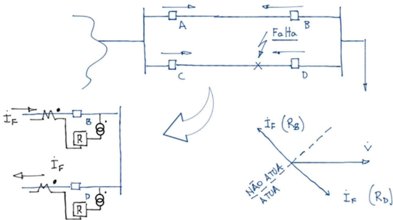
A função comparação de ângulos também pode ser utilizado para discriminar a direção do fluxo de potência ativa em geradores ou motores (função ANSI 32).
