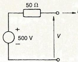
Fig. 2.31 Fonte de tensão equivalente.
