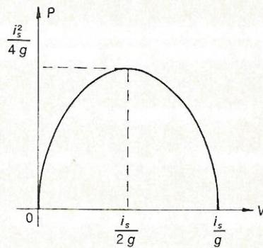
Fig. 2.26 Potência em função da tensão.
