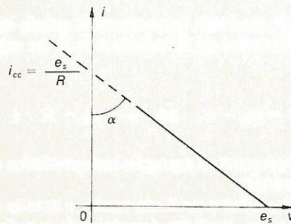
Fig. 2.17 Curva característica da fonte real de tensão.
