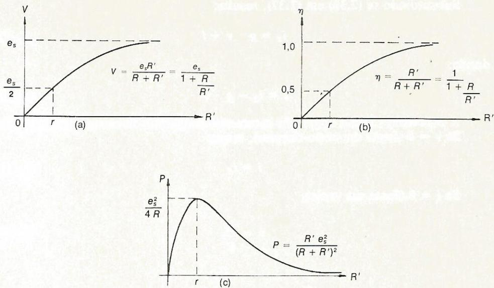
Fig. 2.23 Fonte real de tensão.
