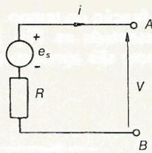
Fig. 2.15 Fonte real de tensão.
