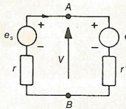
Fig. 2.34 Gerador alimentando um receptor ativo.
