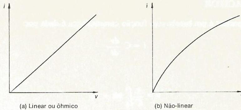
Fig. 2.10 Curvas características de um resistor.
