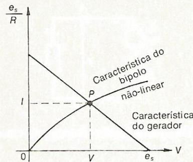
Fig. 2.22 Ponto de operação em bipolo não-linear.
