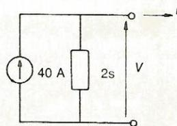
Fig. 2.29 Fonte de corrente equivalente.
