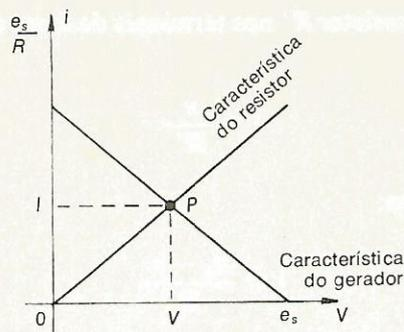
Fig. 2.21 Ponto de operação no resistor.
