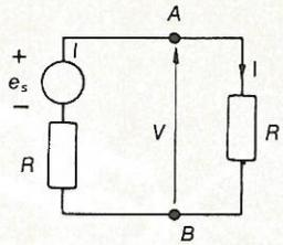
Fig. 2.20 Fonte de tensão alimentando um resistor.
