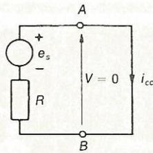
Fig. 2.16 Fonte de tensão em curto-circuito.
