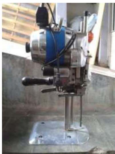
Figura 79 - Exemplo de uma máquina de corte, utilizada na fabricação do revestimento da lancheira
