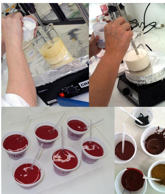
Figura 10: Mistura de base e corantes manualmente
