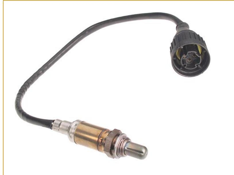
Detectar a concentração de oxigênio nos gases de escape, compara-la ao ar que está localizado internamente na sonda, e por meio de pulsos elétricos, informar a ECU se há excesso ou falta de oxigênio, para que a mesma faça as devidas alterações na proporção da mistura Ar/Combustível.
