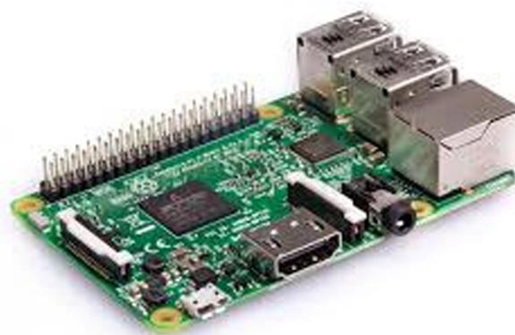
**Figura 10:** Raspberry Pi 3 utilizado como computador de visualização dos dados, o Arduino comunica-se com este embarcado via comunicação serial.
