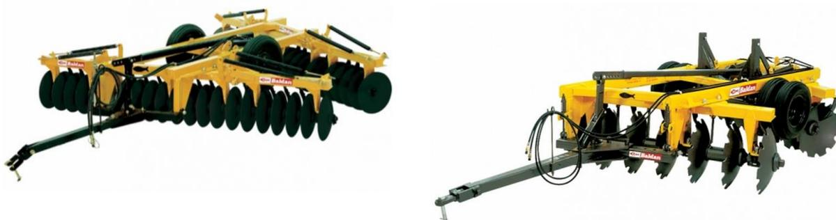
Figura 5 – Grade niveladora com discos de 20” acima, e grade aradora pesada com discos de 34 polegadas, utilizadas no preparo de solo na cultura do algodão. Fonte: Baldan, 2011.
