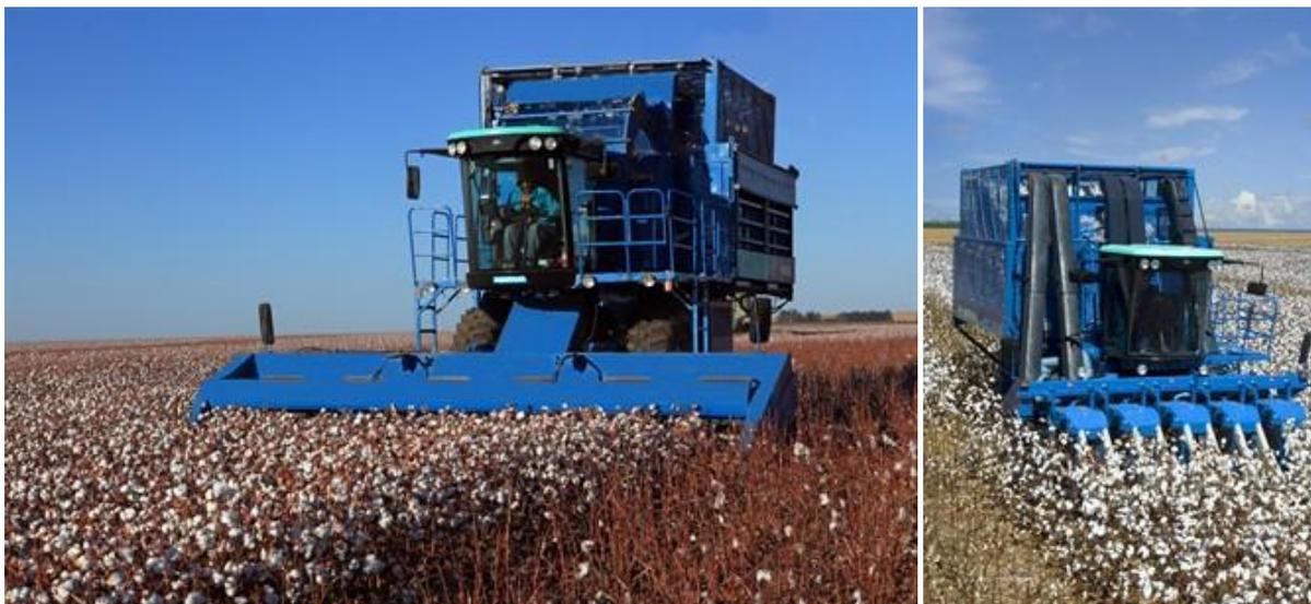
Figura 9 – Colhedora do tipo stripper à esquerda e do tipo picker à direita. Fonte: Montana, 2011.
