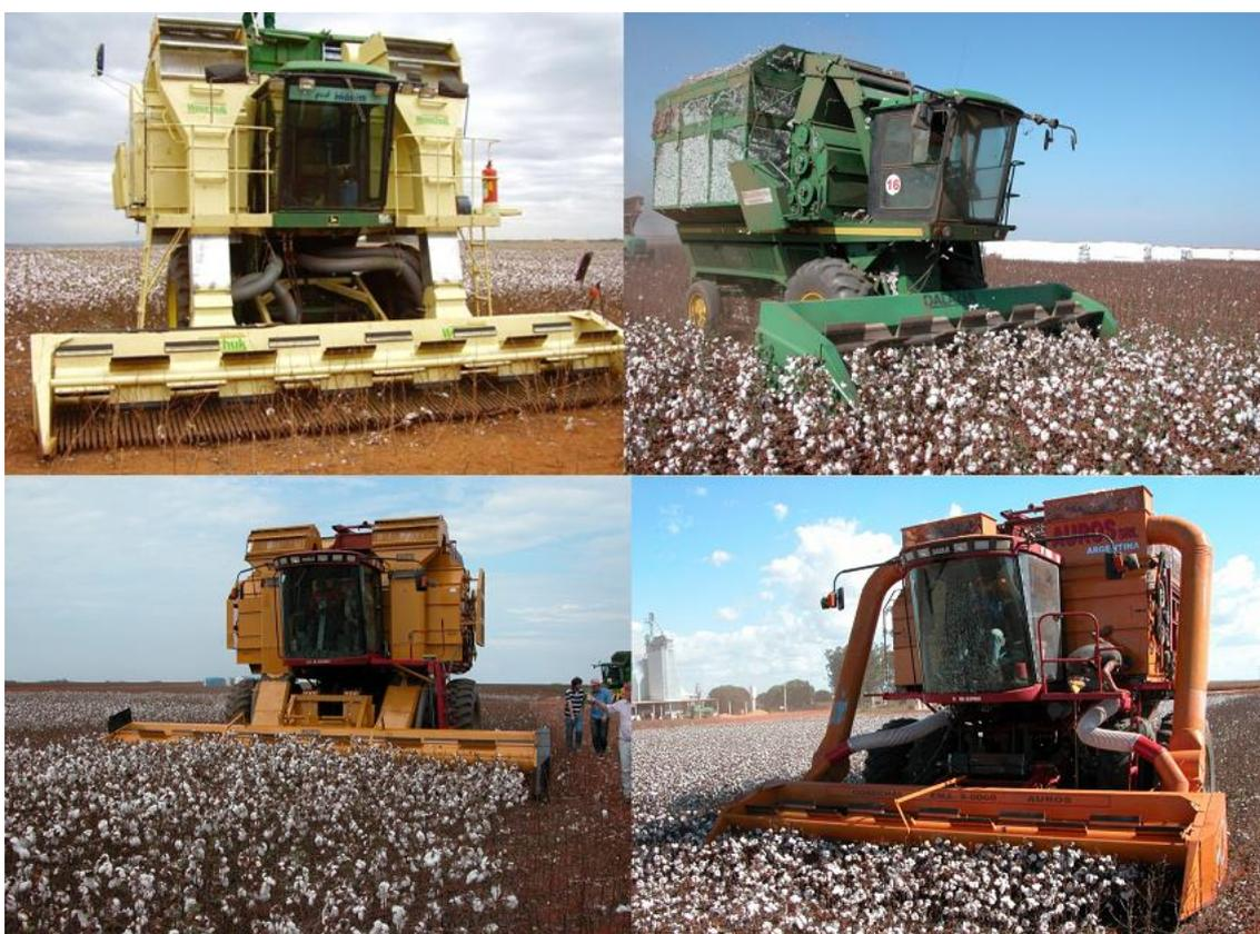
Figura 15 – Diversos equipamentos para colheita utilizando plataforma stripper de pentes. Fonte: Da Silva et al.,2010.
