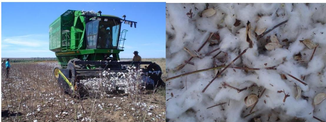
Figura 20 – No lado esquerdo, colheita de algodão com colhedora do tipo stripper, à direita detalhe das impurezas presentes nas fibras. Fonte: FACUAL, 2005.
