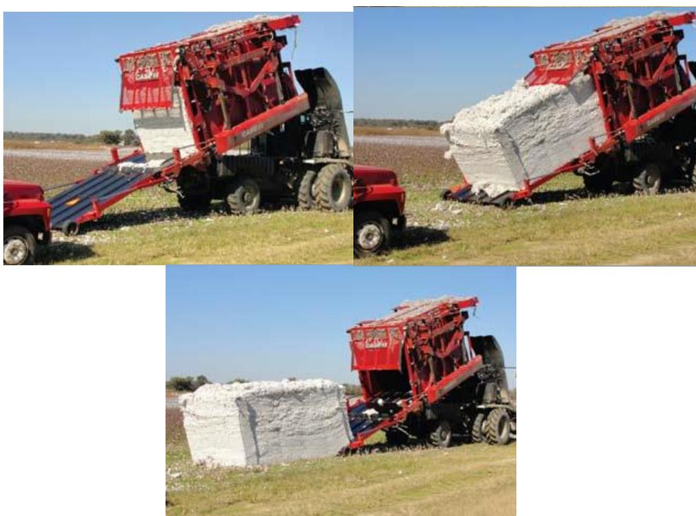
Figura 13 – Sistema Module Express do fabricante CASE IH
