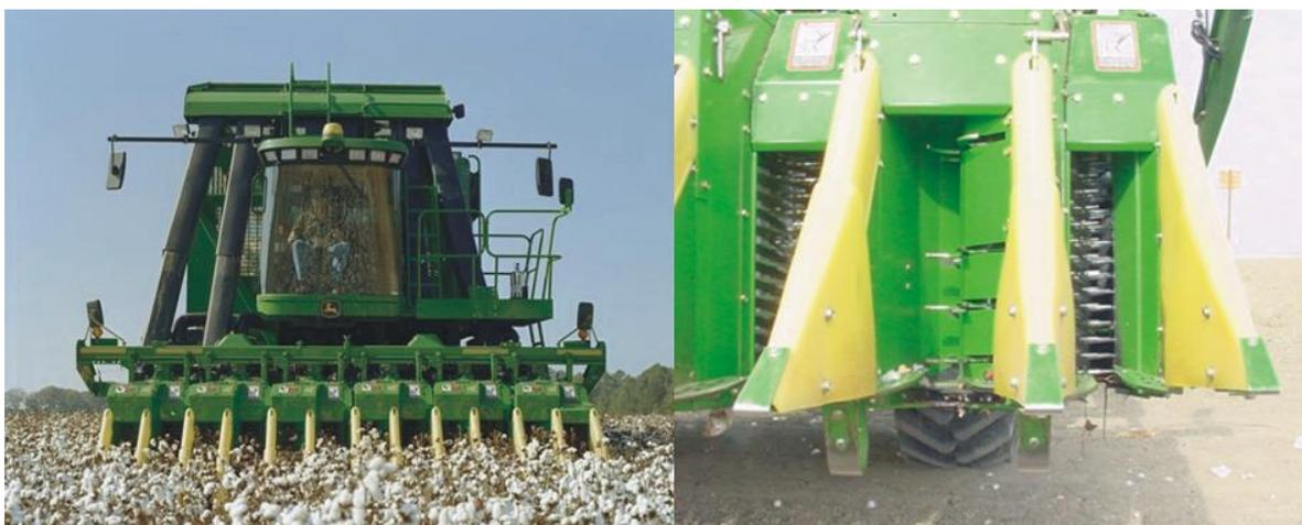
Figura 21 – Colhedora de fusos equipada com unidades colhedoras para espaçamento reduzido.
