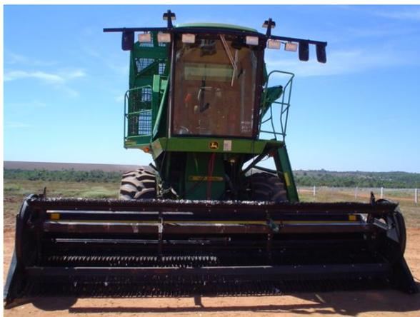
Figura 19 – Colhedora John Deere 7455 equipada com plataforma stripper. . Fonte: FACUAL, 2005.
