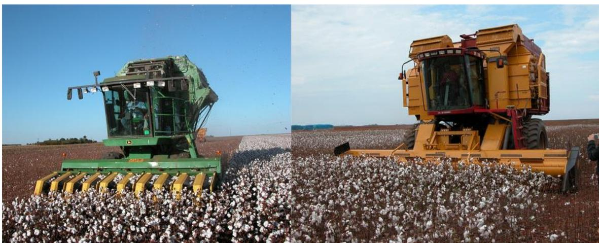
Figura 16 – Plataformas para colheita do tipo stripper do fabricante nacional Busa, à esquerda plataforma de escovas e à direita de dedos.
