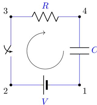
Já que o potencial em um certo ponto é determinado univocamente pelo ponto em que estamos, ao partir de 1 e circularmos, em sentido horário, o circuito, não deve haver diferença de potencial. Assim, partindo de 1 e analisando as quedas de potencial,
