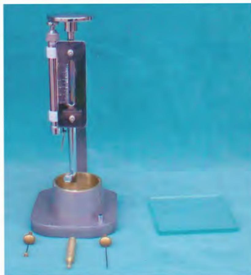
**FIGURA 5-13** Penetrômetro Vicat utilizado para determinar o tempo de presa inicial de produtos de gesso.
