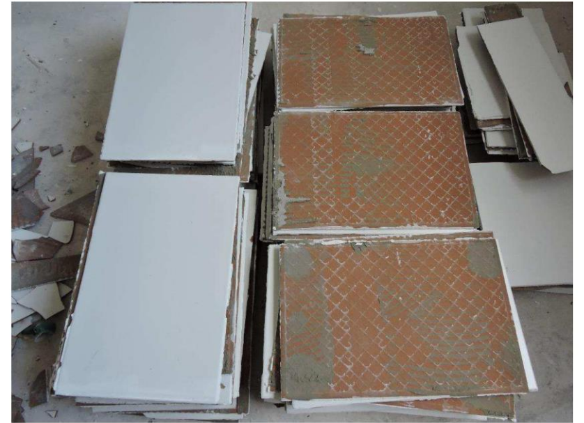
Asas de material removido em decorrência de ruptura entre o revestimento e a argamassa diante por solicitações posteriores ao assentamento: fato recorrente observado de forma generalizada
