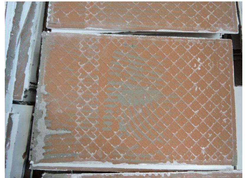
Asas de material removido em decorrência de ruptura entre o revestimento e a argamassa diante por solicitações posteriores ao assentamento: fato recorrente observado de forma generalizada
