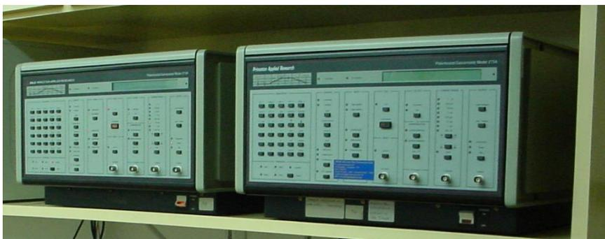
**Potenciostato utilizado para obtenção de curvas de polarização. Existem diversos modelos disponíveis. Atualmente, alguns dele cabem na palma da mão. (Fonte: dissertação de Rodrigo César Nascimento Liberto. PMT-EPUSP. 2004.)**
