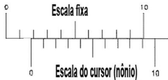
Obs.: A peça a ser medida deve ficar numa posição tal que deixe o vernier do paquímetro perpendicular à sua visão para evitar erros de paralaxe.
