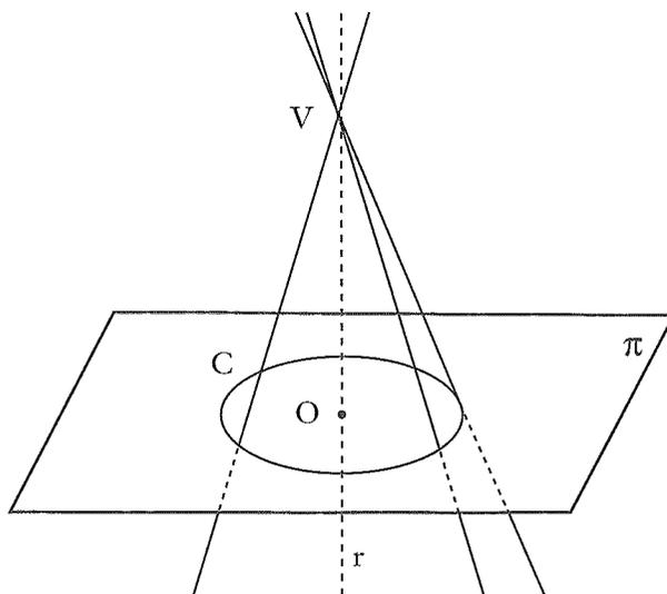
O conjunto  $S$ , formado pela reunião das retas determinadas pelo ponto  $V$  e pelos pontos de  $C$ , é chamado de **superfície cônica de revolução**.
