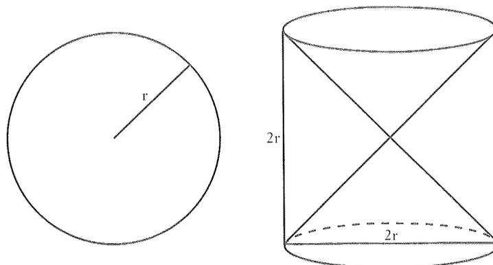
Observemos que, cortando a esfera e o espaço entre o cone e o cilindro por um plano que dista  $h$  do centro, obtemos, em ambos os casos, uma área que é dada por  $\pi(r^2 - h^2)$ . O corte da esfera gera círculos de raio  $\sqrt{r^2 - h^2}$  (pelo Teorema de Pitágoras) e, portanto, tem área  $\pi(r^2 - h^2)$ ,
