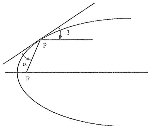
Por outro lado, os raios de uma fonte de luz pontual colocada no foco, depois de refletirem na parábola, são irradiados numa direção paralela ao seu eixo. Essa é a razão de os espelhos dos faróis dos automóveis serem parabólicos.
