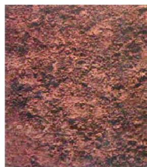
Grau D – Substrato de aço onde a carepa de laminação foi eliminada pela corrosão e com formação de cavidades visíveis.
