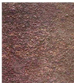
Grau C – substrato de aço onde a carepa de laminação foi eliminada pela corrosão ou que possa ser removida por raspagem, com pouca formação de cavidades visíveis.
