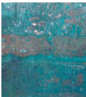
Grau A – substrato de aço sem corrosão, com carepa de laminação aderente.
