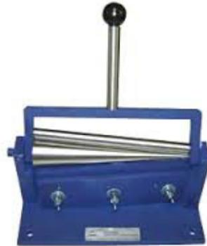
Figura 12 – Mandril cônico utilizado nos ensaios para avaliar a flexibilidade de tintas.
