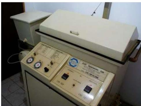
Figura 6. Câmara de névoa salina para ensaios acelerados de corrosão.
