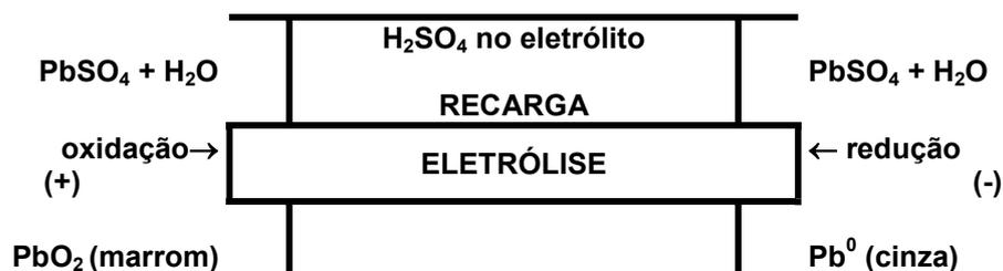
**Figura 5**– Esquema de funcionamento de um acumulador de chumbo-ácido
