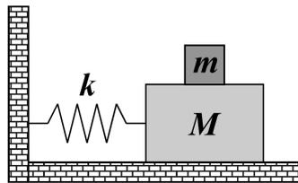
Para  $x > 0$ , no referencial não inercial do bloquinho ele sente uma força fictícia  $-ma$  e a força de atrito máximo  $-\mu_e mg$ , de modo que a condição de equilíbrio fica  $-ma = \mu_e mg$ , de onde vem
