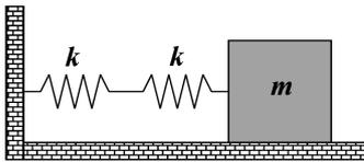
**Solução:** no primeiro caso as forças das duas molas que atuam no bloco tem mesma direção, mesmo sentido e mesma intensidade, de modo que a segunda lei de Newton  $\sum F = ma$  aplicada no bloco fica  $-2kx = m\ddot{x}$ , que fornece a equação diferencial
