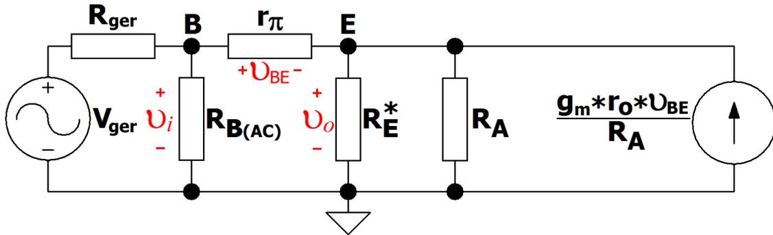
Figura 10 – Circuito da Figura 9 com a Malha de Coletor Compactada.
