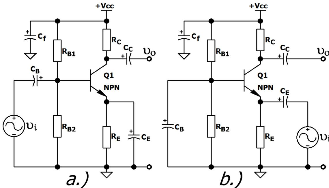
Figura 7 – Amplificadores Básicos. a.) *EC* com  $R_E$  Desacoplado. b.) *BC* com  $R_B$  Desacoplado.
