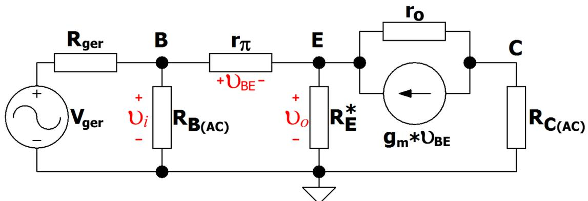
Figura 9 – Modelo Linearizado para Pequenos Sinais e Baixas Frequências do Amplificador Coletor-Comum.
