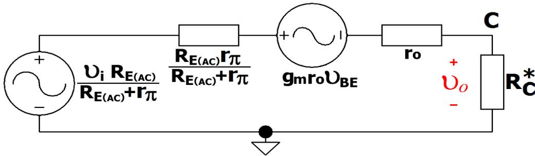
Figura 3 - Amplificador EC com Modelo Compactado a Partir da Entrada.
