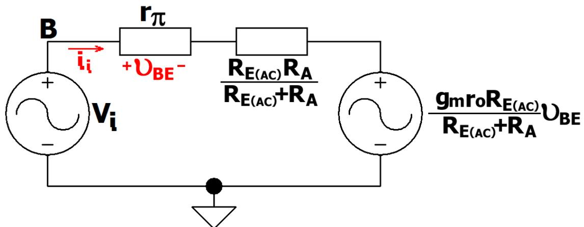
Figura 2 – Amplificador *EC* com Modelo Compactado a Partir da Saída.
