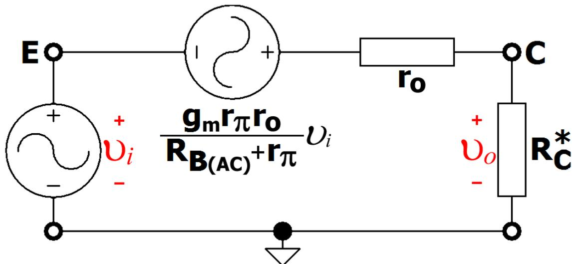
Figura 6 - Amplificador BC com Modelo Compactado a Partir da Saída.
