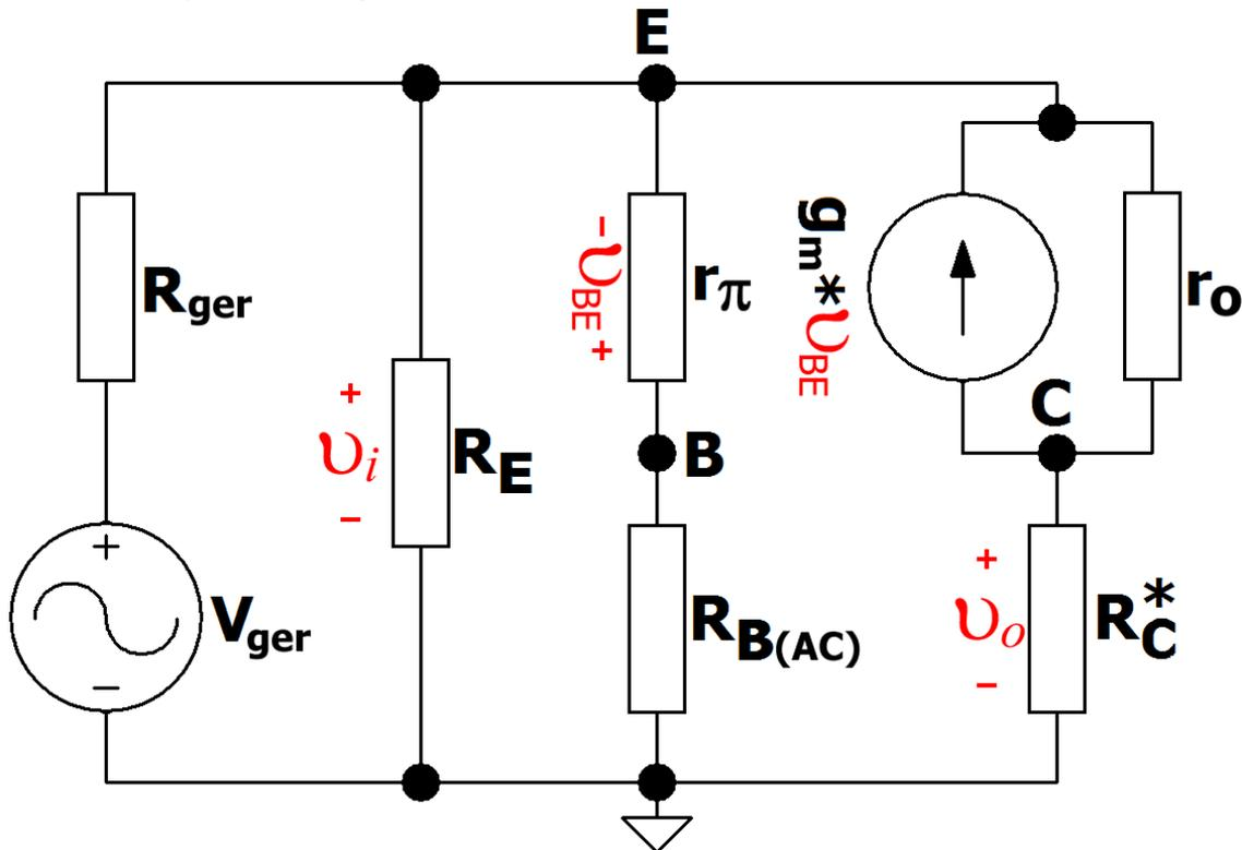
Figura 5 - Modelo Linearizado do Amplificador BC Genérico.
