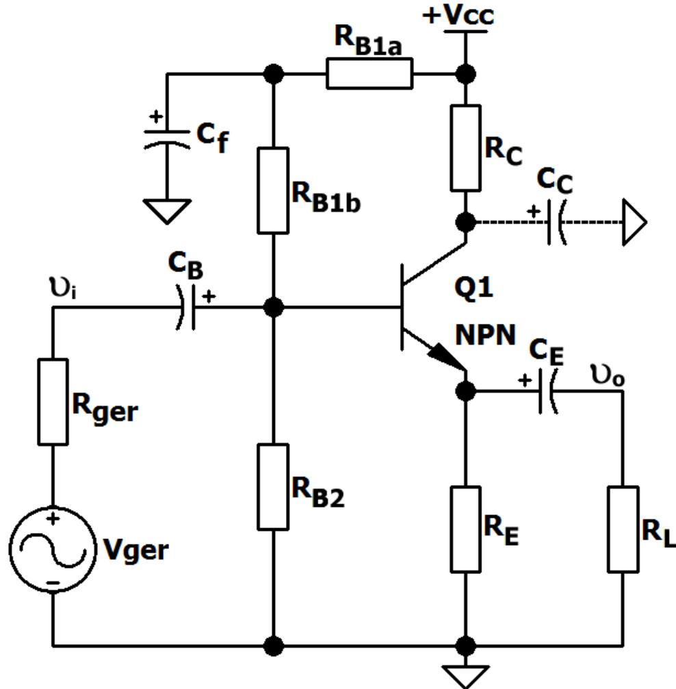
Figura 8 – Amplificador Coletor-Comum Genérico.
