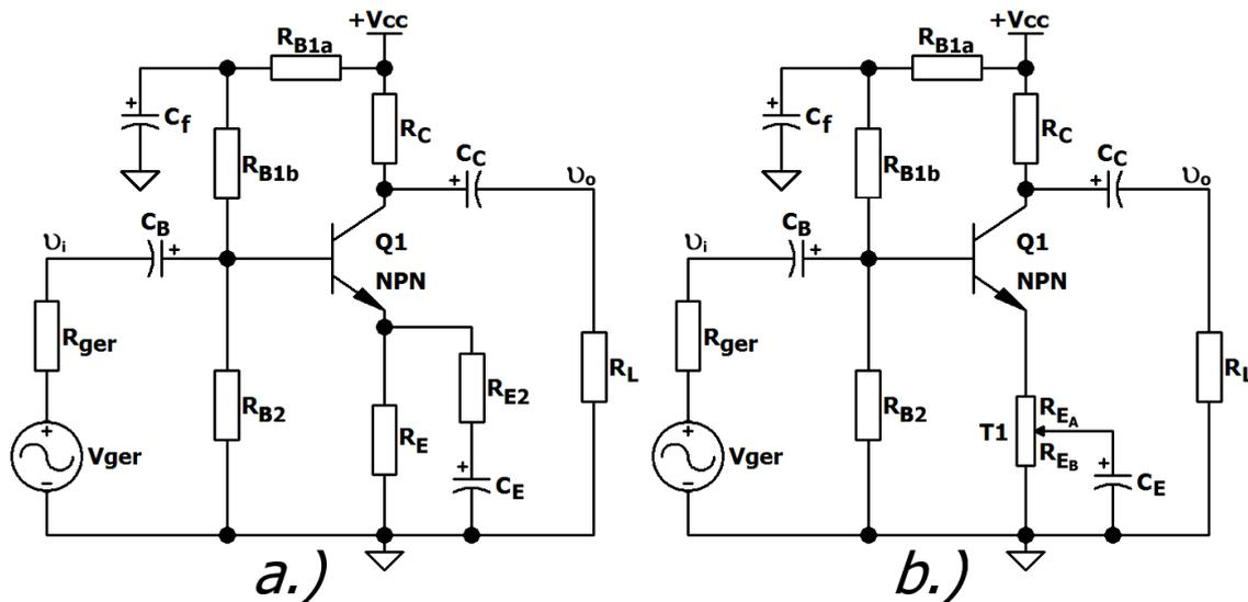
Figura 4 – Amplificadores EC Genéricos. a.) Com Ganho de Tensão Fixo. b.) Com Ganho de Tensão Ajustável.
