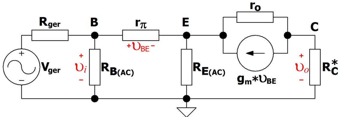
Figura 1 – Modelo Linearizado do Amplificador *EC* Genérico.
