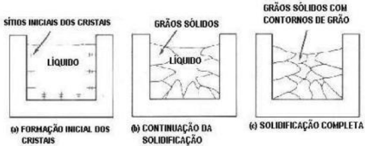
Estágios de formação de grãos metálicos durante a solidificação de um metal fundido
