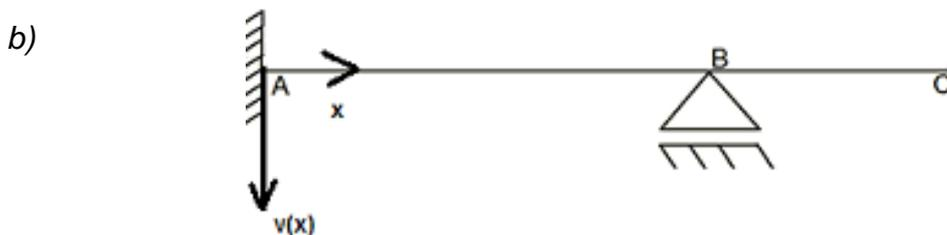
31. O poste é engastado no solo e tem uma força concentrada aplicada no ponto indicado na figura. Seu valor é devido ao peso dos cabos de energia elétrica de  $P = 5$  kN, de modo a estar atuando no seu plano médio, inclinado com a vertical em um ângulo de  $\theta = 30^\circ$ . A seção transversal (ST) de todo o poste é indicada. A força  $P$  e as cotas das distâncias  $R$  e  $L$  estão com referência ao CG da
