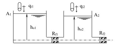
2-) Dado o sistema fluídico da figura abaixo, obtenha um modelo matemático deste modelo, estabelecendo hipóteses simplificadoras. Obtenha em seguida as F.T. linearizadas do sistema para as entradas e saídas mostradas.
