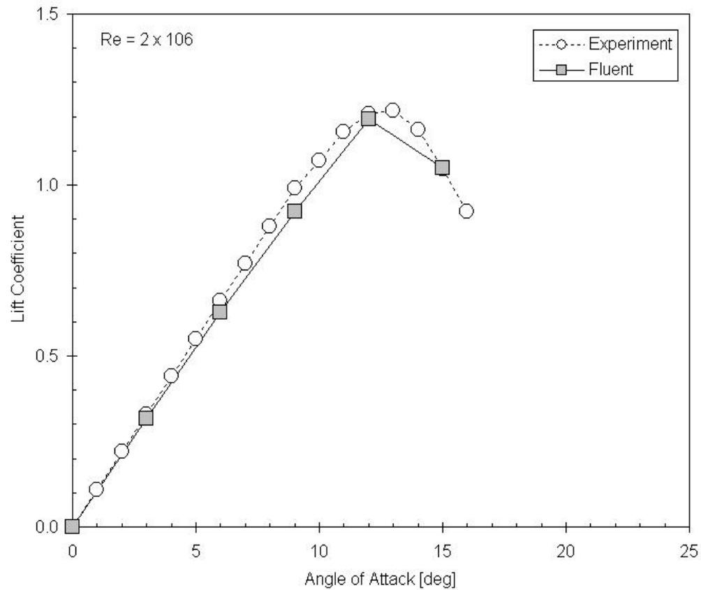
Curva  $C_L \times \alpha$  de um aerofólio simétrico NACA 0012. Extraído de [https://www.cfd-online.com/Wiki/NACA0012\\_airfoil](https://www.cfd-online.com/Wiki/NACA0012_airfoil).
