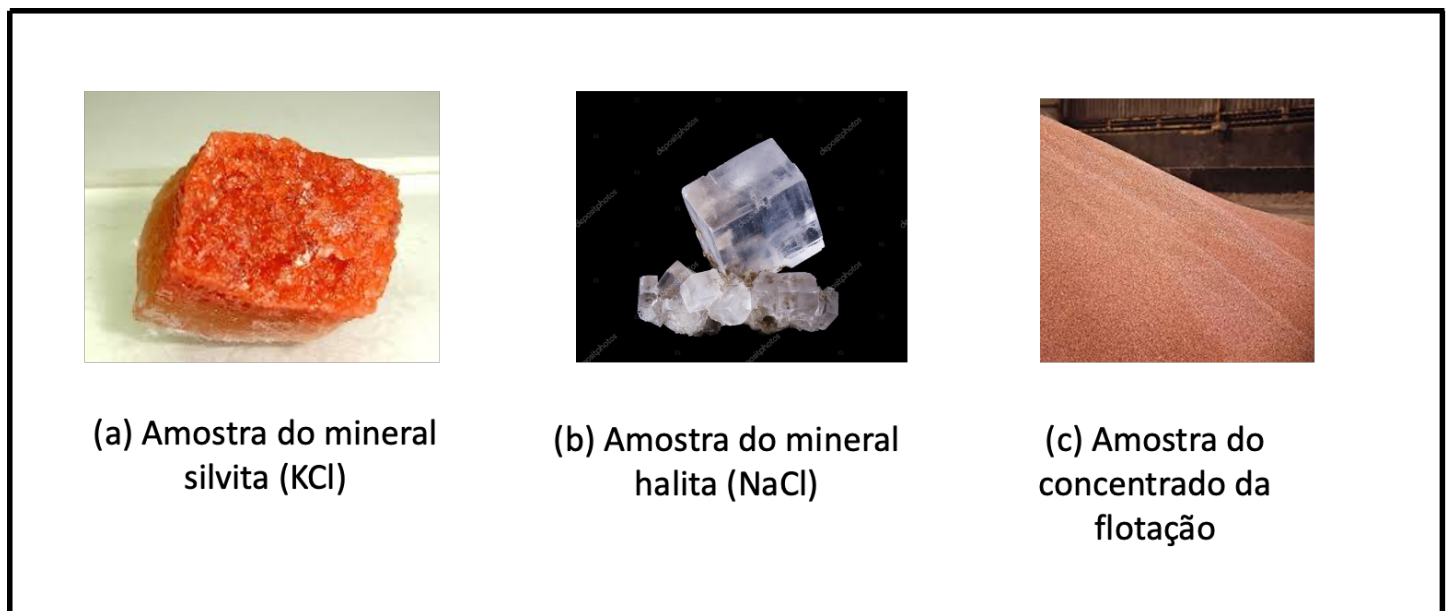
Figura 8.1 – Ilustração de amostras do mineral silvita (a), halita (b) e do concentrado da flotação (c).
