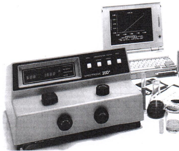
➤ Fig. 6.12 Espectrofotômetro. Este instrumento pode ser utilizado para se medir o crescimento bacteriano pela determinação do grau de transmissão de luz através da cultura. Amostras de culturas contidas em tubos especiais opticamente transparentes são colocadas dentro do espectrofotômetro (dentro de um suporte à direita do aparelho) e são medidas em relação aos padrões.
