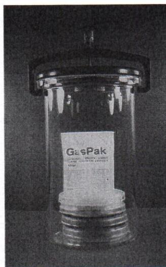
> Fig. 6.21 Incubadora de CO<sub>2</sub>. Quando ativados, estes reagentes químicos removem o oxigênio e são colocados junto às culturas em uma jarra lacrada para criar uma câmara anaeróbica. Este sistema é útil para um laboratório pequeno que possua apenas poucas placas a serem incubadas anaerobicamente.
