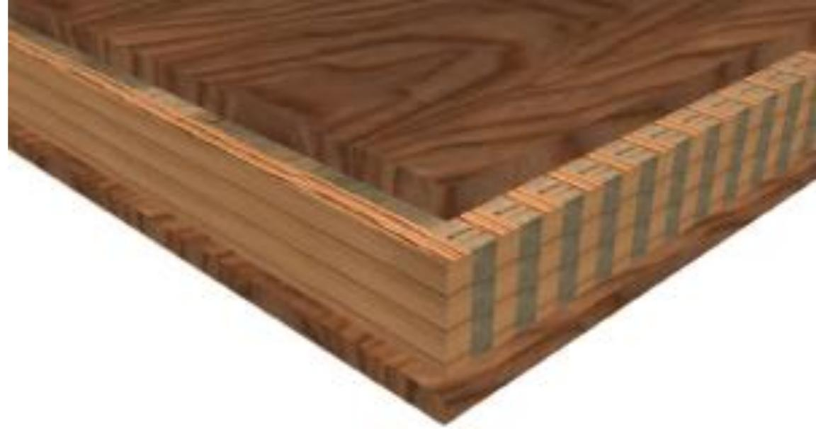
O compensado multi-sarrafeado possui qualidade superior ao anterior, pois é formado pela junção de **lâminas de aproximadamente 3mm coladas e prensadas na vertical**, aumentando a sua resistência ao empenamento. Esse miolo é então **revestido com lâminas similares** ao do tipo laminado.
