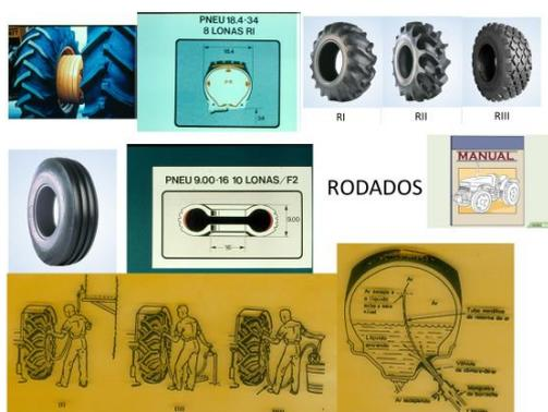
Os pneus têm várias funções: apoio, sustentação, direcionamento e gerar esforço de tração. Eles são empregados em vários tipos de máquinas e equipamentos, desde no automóvel de passeio, caminhões, aviões, equipamentos industriais, tratores agrícolas e outros. A escolha de um pneu é um ponto fundamental pois ele é o elo entre a transmissão (veículo) e a superfície de apoio. Escolher pneu errado é como “andar de sapato social na lama”.
