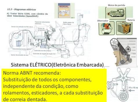
O sistema elétrico é constituído basicamente pela bateria, alternador, motor de partida, fiação, lâmpadas e, mais recentemente, toda a eletrônica embarcada para o gerenciamento e monitoramento das funções do trator. Os cuidados básicos referentes a esse sistema consistem em verificar e ajustar a tensão da correia de acionamento e verificar o estado de fiação e lâmpadas. Um ponto básico é evitar molhar os componentes. O manual do trator traz as recomendações para esse sistema.
