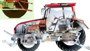
Um trator agrícola é constituído basicamente de: motor, transmissão, rodados, sistema de direção, levantamento hidráulico, de freios, cabine (quando existir).
