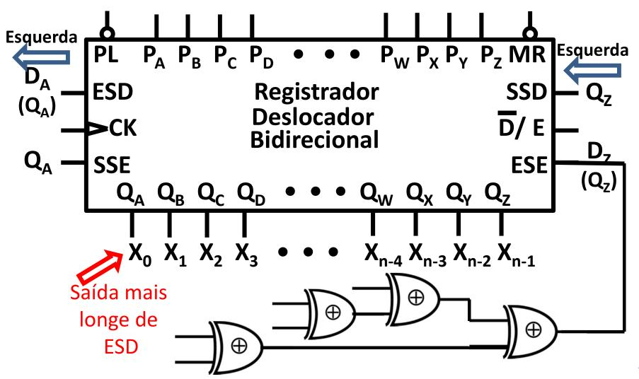
Estrutura de LFSR, n = 2 bits – Função linear com 2<sup>2</sup> – 1 estados na sequência principal:
