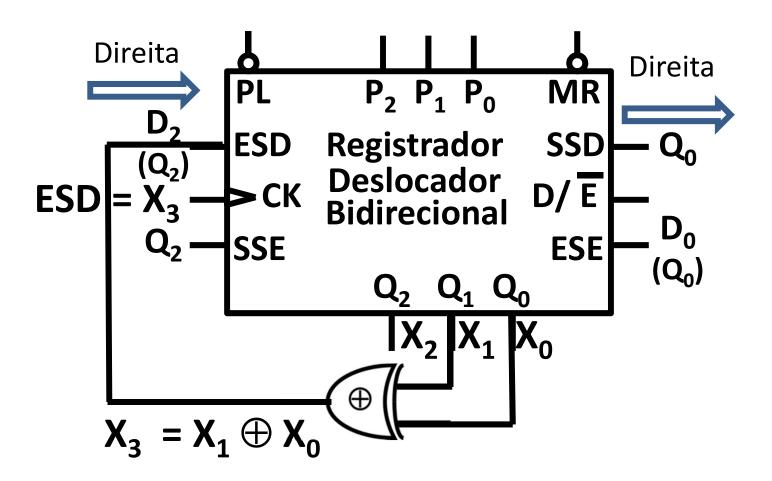
Linear Feedback Shift Register (LFSR) – Sequência principal de 2<sup>3</sup> – 1 estados:
