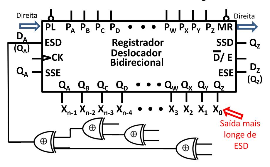
Estrutura de um LFSR de n bits, genérico:
