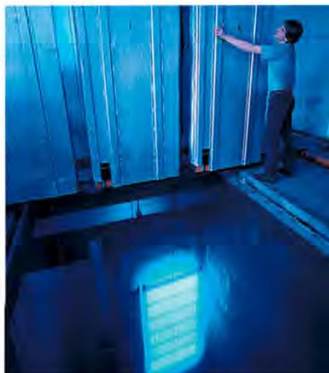
(b) A fonte de irradiação está na posição mais baixa da cavidade de armazenamento. O brilho azul é a radiação Cerenkov causada pelas partículas carregadas que ultrapassam a velocidade da luz na água.
