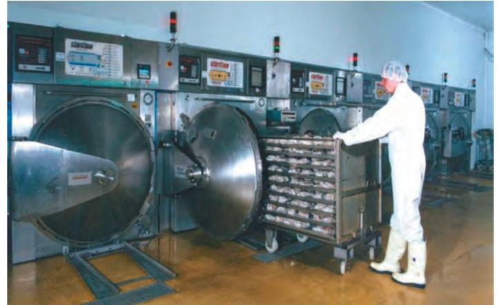
**Figura 28.2 Retortas para enlatamento comercial.** Esse processo é mais utilizado do que a esterilização por autoclave, utilizada em muitos laboratórios de microbiologia ou hospitais.
