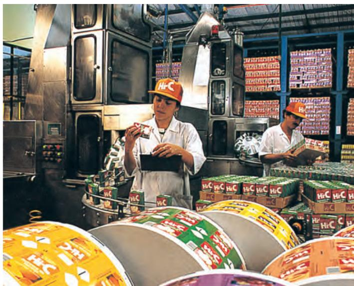
**Figura 28.4 Empacotamento asséptico.** Rolos do material de empacotamento em primeiro plano, pacotes cheios no centro à direita.
