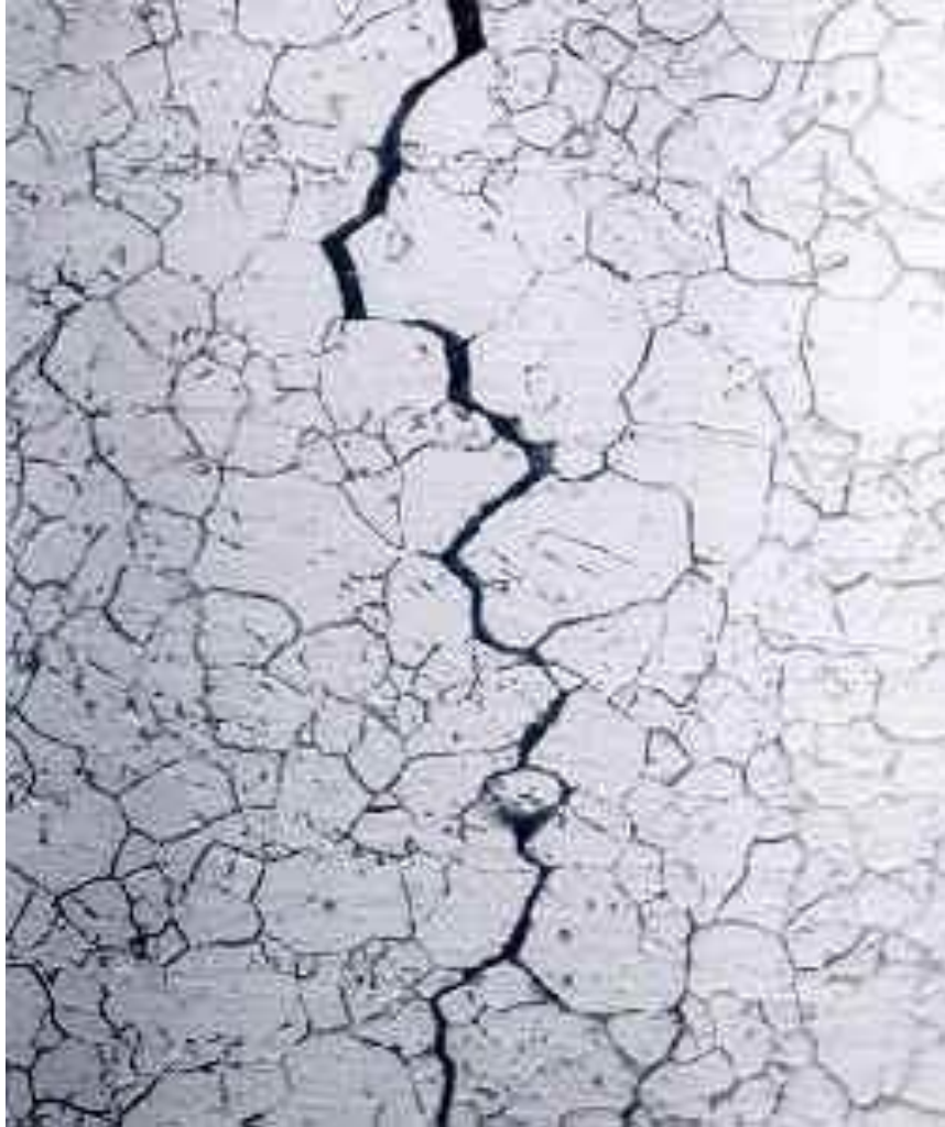
CST intergranular de um tubo de trocador calor de Inconel
