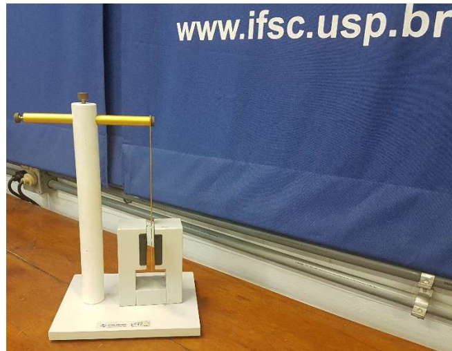
Figura 6 – Montagem com pêndulo físico para demonstração de fenômenos sobre corrente de Foucault.
