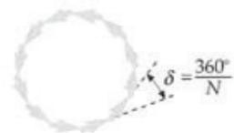
**FIGURA 33-25** Diagrama de fasores para calcular o primeiro mínimo em um padrão de difração de fenda simples. Quando as ondas de  $N$  fasores se cancelam completamente, os  $N$  fasores formam um polígono fechado. A diferença de fase entre as ondas de fontes adjacentes é, então,  $\delta = 180^\circ/N$ . Quando  $N$  é muito grande, as ondas da primeira e última fontes estão aproximadamente em fase.
