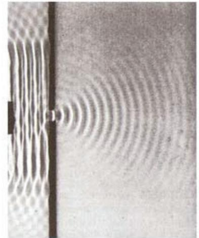
**FIGURA 33-6** Ondas planas na água em um tanque encontram uma barreira que tem uma pequena abertura. As ondas à direita da barreira são circulares e concêntricas em torno da abertura, como se houvesse uma fonte puntiforme na abertura.
