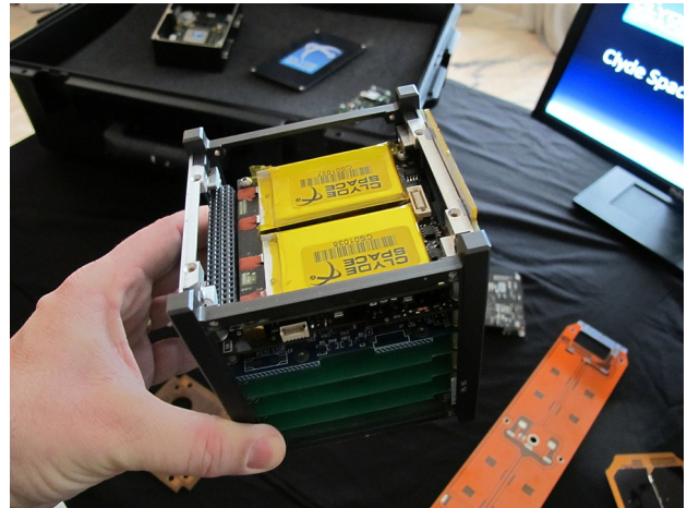
Figura 1: 1U CubeSat (Fonte: Wikipedia)
