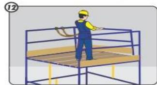
12 Piso com forração completa, antiderrapante, nivelado e fixado de modo seguro e resistente
