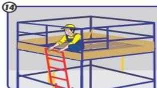
14 Encaixe do último módulo da escada metálica, após a colocação do guarda-corpo
